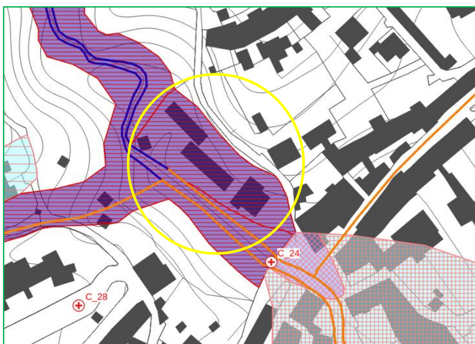
Figura 28 – Dettaglio della vecchia cassa di espansione del Torrente Rova, successivamente urbanizzata ma ancora a rischio di dissesto torrentizio
