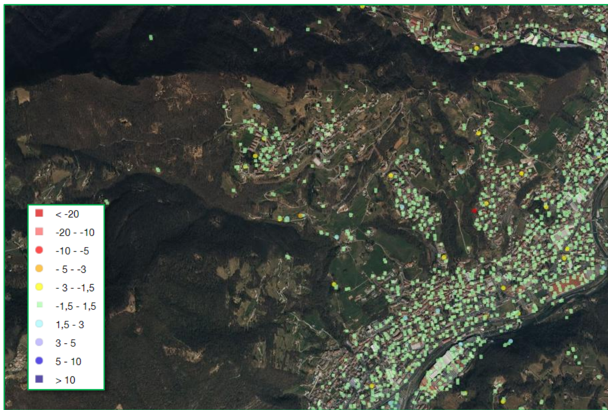
Figura 42 - Dati di interferometria radar satellitari DESCENDING per il territorio di Gazzaniga (da Geoportale regionale)
